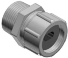
La garniture en néoprène résistante à l'huile et à l'eau est conçue tout spécialement pour assurer l'étanchéité autour des câbles d'alimentation souterrains. Une bague de retenue en acier inoxydable fournit une surface portante pour l'écrou-étoupe et élimine la torsion du câble. L'écrou-étoupe nervuré est robuste et facilement resserré à l'aide d'une clé anglaise pour assurer une connexion de grande résistance.
