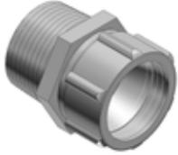
La conception du raccord permet son utilisation avec une plus grande gamme de cordons tout en assurant une traction maximale. La garniture en néoprène est résistante à l'huile, à la lumière du soleil et à l'eau. Le gland hexagonal et le corps du raccord requiert la même grosseur de clé et une bague de retenue coulissante en acier inoxydable empêche le câble de se tordre lorsque celle-ci est serrée. Les filetages NPT assure l'étanchéité du raccord à l'eau.
