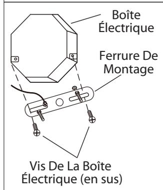
3. Posez la ferrure d'installation à la boîte de sortie électrique à l'aide des vis de la boîte (en sus). Assurez-vous que les goujons de la ferrure d'installation font face vers l'extérieur de la boîte électrique.
