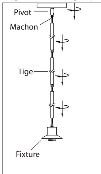
1. Installez la longueur de colonne requise en faisant passer le fil dans la colonne puis en vissant la colonne sur le luminaire. Installez le pivot sur la colonne en vous assurant que le manchon est au niveau du pivot.
