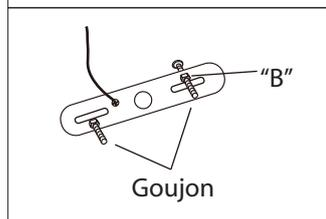
2. Dévissez l'écrou B. Ajustez le poteau à la longueur désirée et barrez en place avec cet écrou.
