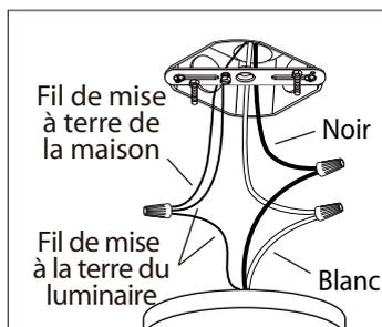
4. Branchez les fils de la mise a terre (cuivre nu ou vert) de votre montage au fil de la mise A terre (cuivre nu ou vert) ou vis de la mise a terre dans la boîte électrique. Posez le fil noir (ou fil ayant un écriteau) de la fixture au fil noir dans la boîte électrique et posez le fil blanc de la fixture au fil blanc dans la boîte.
