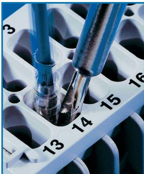
À l'aide d'un tournevis à bout étroit, pousser la patte d'entrée des fils pour faciliter le retrait d'un contact
