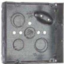
Boîte carrée en acier pré-galvanisée 4 po, 2-1/8 po profond, 30,3 po cu . Construction soudée avec débouchures 1/2 po et 3/4 po.
