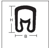
Marqueurs combinés fermés. Grippage permanent des fils et manchon de grandeur adaptable pour le marquage de fils non connectés. Profil unique à soufflet à action de ressort pour toute une gamme de diamètres de fils. Protection anti-rotation pour assurer la facilité du marquage.
