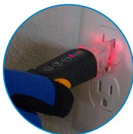
**Détecte une tension CA dans des prises de courant**
