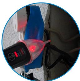
**Détecte une tension CA dans des conducteurs**
