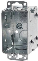
Boîtes pour dispositifs pour installation sur une structure en bois, dans un mur. Permet l'installation de dispositifs électriques. Produit fourni avec des entrées défonçables pour l'utilisation de conduits ou de raccords de câbles.
